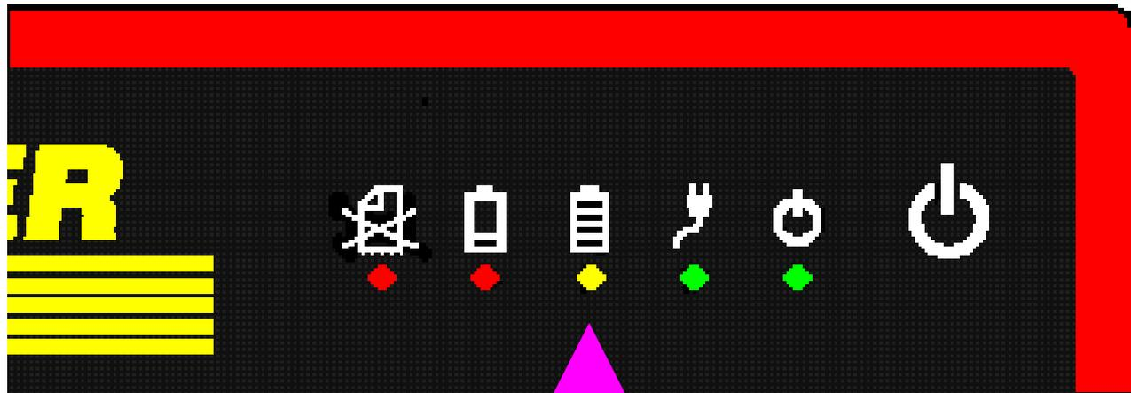
**Indica che la ricarica degli accumulatori è in corso. Si spegne quando le batterie hanno raggiunto il 100% della carica.**
